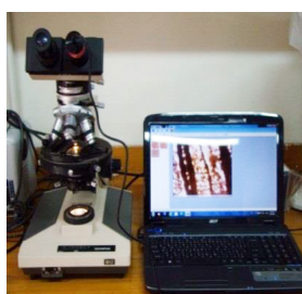
تصویر ۷. میکروسکوپ نوری nikon مجهز به Dino light منبع: ؟
