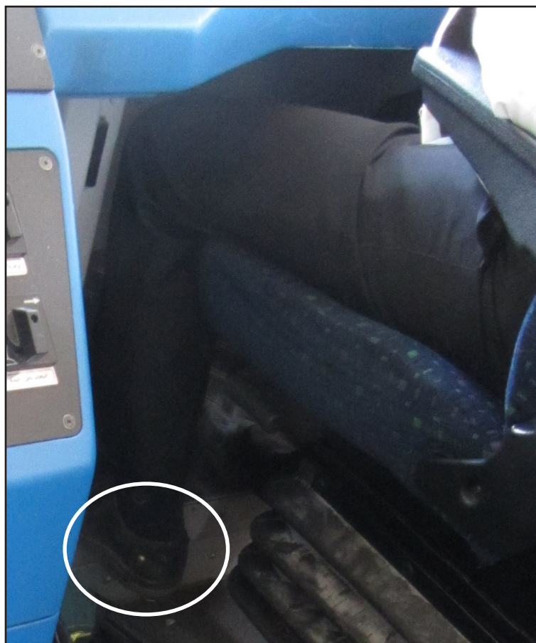
تصویر ۶: معلق بودن پاشنه پای لکوموتیوران در هنگام فشردن پدال پای سیستم داده‌شده‌اند (مأخذ: نگارندگان)
